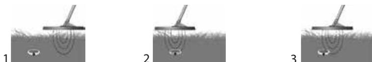
Positionnez votre disque à environ 2 à 5 cm du sol et à distance de la cible à détecter. Puis pressez ⊕ pour calibrer le seuil.
